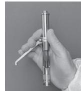
On arme l'appareil en le tenant **verticalement** par abaissement du levier (N° 126).
